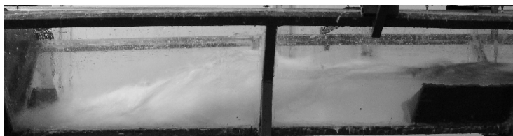
Figure 2 : Photographie d'un ressaut hydraulique de type A forcé par marche positive.
